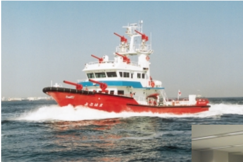
(参考1) 平成13年度に横浜市が整備した広域応対対応型消防艇(120トン級)
